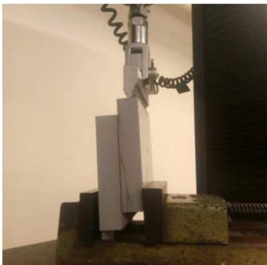
Figura 1. Montaje de la probeta en el soporte de ensayo a la cizalla de la máquina de ensayos universales.
